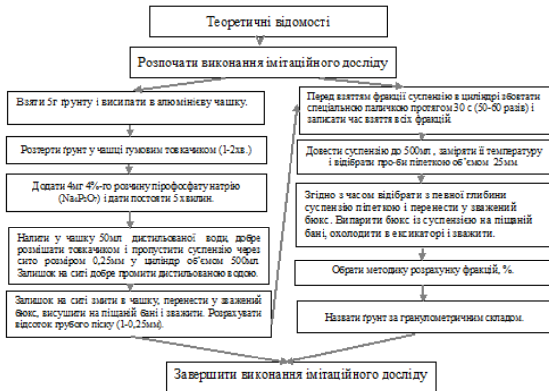
Рис. 1. Фрагмент алгоритму віртуального визначення гранулометричного складу ґрунту
